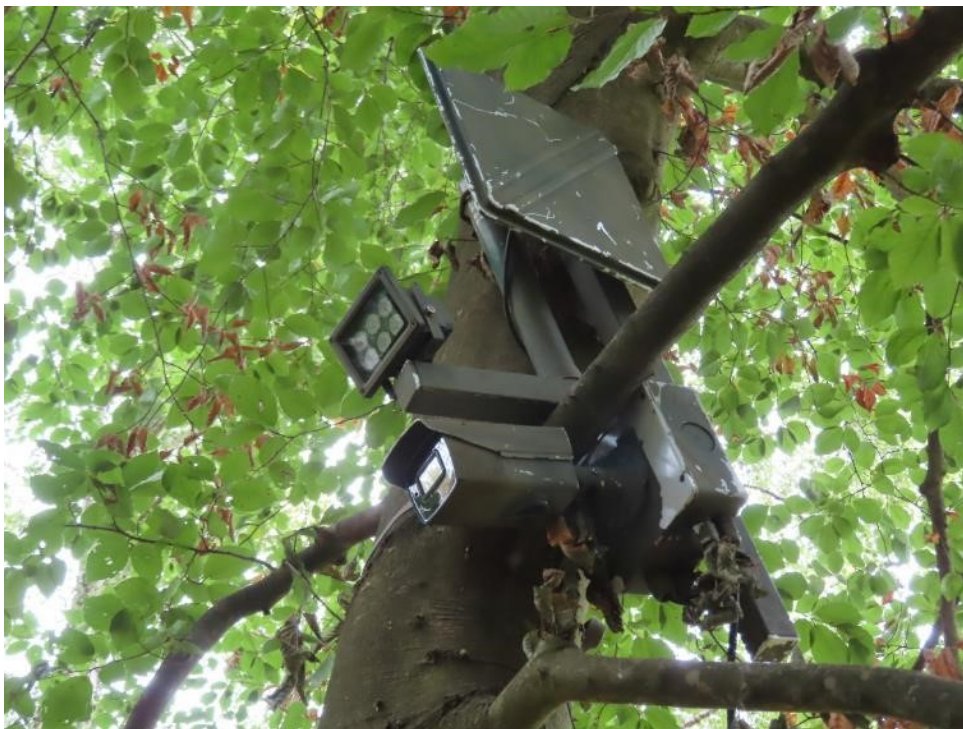
Abbildung 36: Funkbasiertes Fangüberwachungssystem mit leistungsfähiger Kamera und IR-Scheinwerfer (Foto: Dr. Egbert Gleich)
