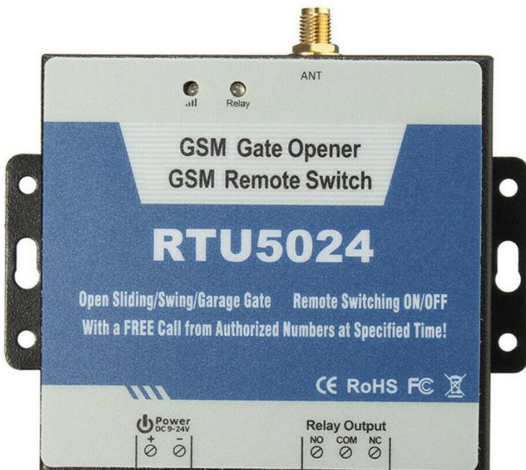
Abbildung 16: Beispielhafte Darstellung GSM Toröffner als sehr geeignetes Instrument zur Ansteuerung des Auslösemechanismus des Saufangs (Foto: Dr. Jörg Melzheimer)
