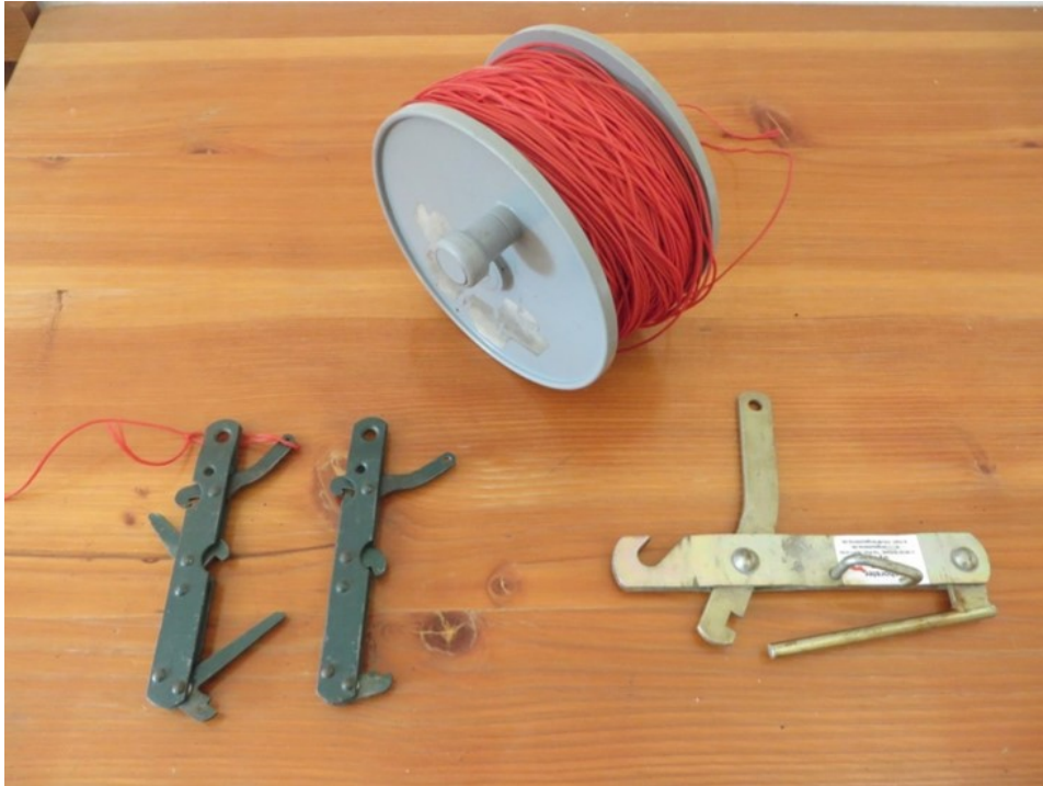
Abbildung 12: manuelles Fangschloss (grün) im ausgelösten (links) und gespannten (rechts) Zustand, dazu die Auslöseleine. Das messingfarbene Fangschloss stellt eine alternative Bauform dar (Foto: Dr. Jörg Melzheimer)
